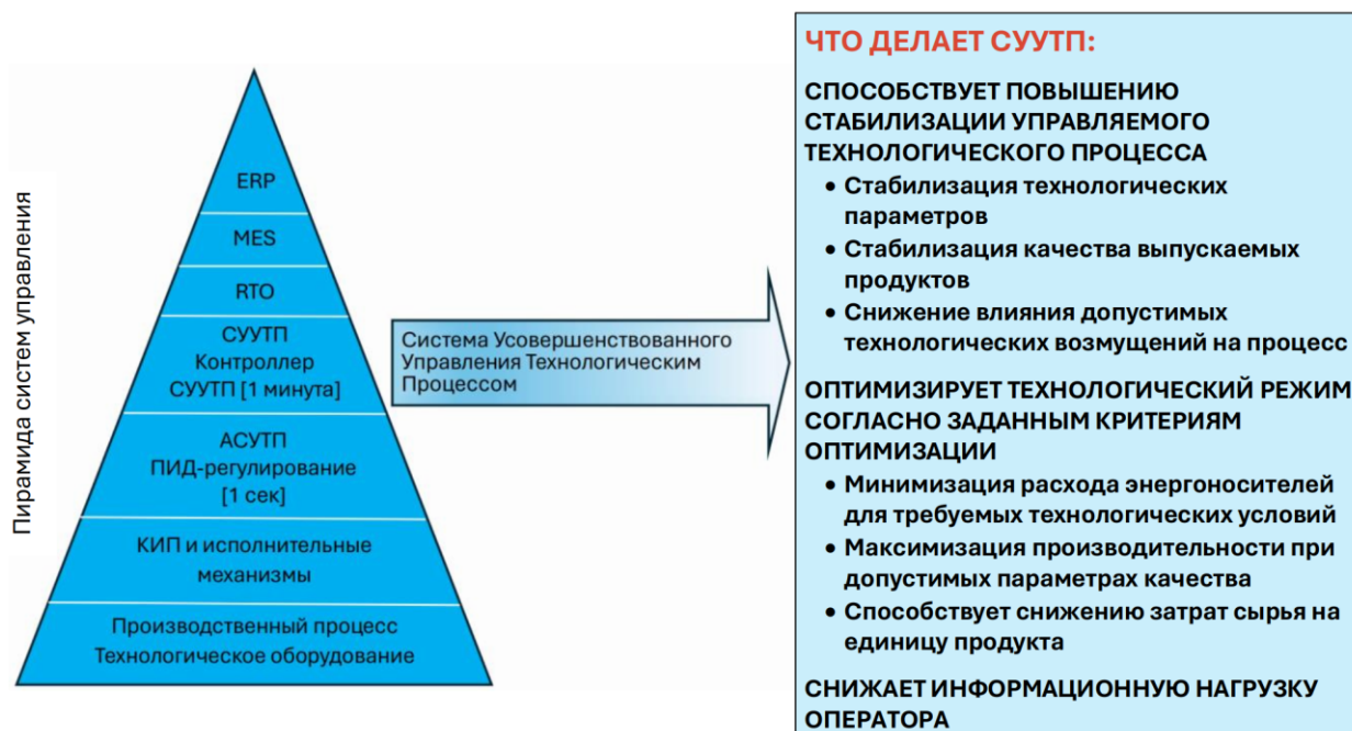
Рисунок 1.2 – Система СУУТП – это программно-аппаратный комплекс
