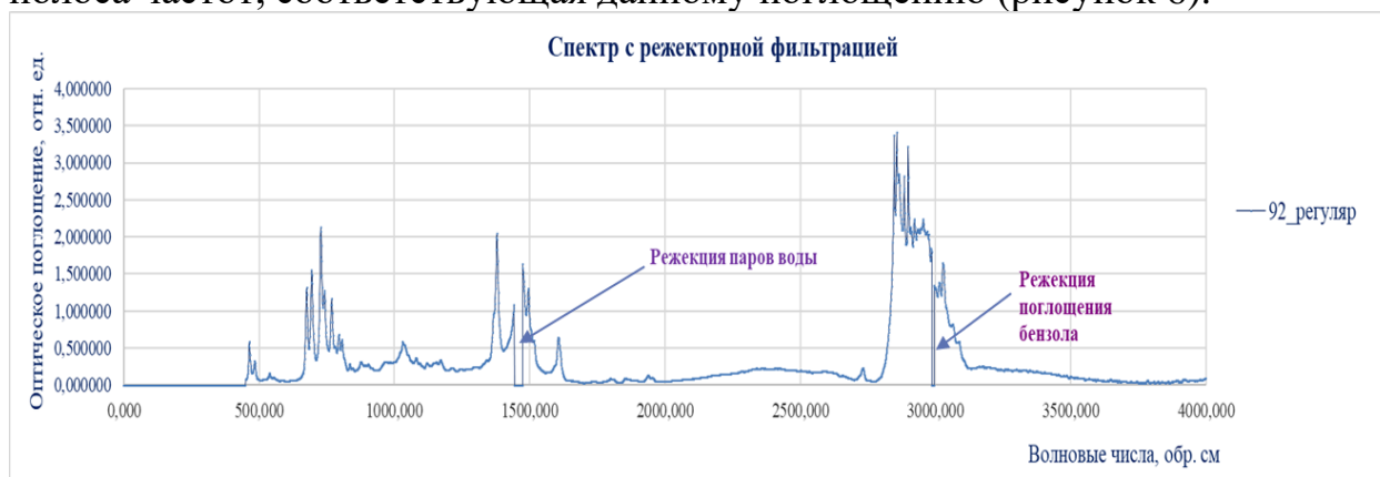
Рисунок 6 – Пример работы фильтра частот, соответствующих поглощению паров воды
