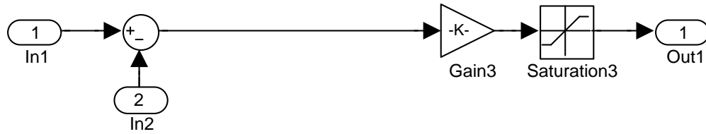
Рисунок 3.10 - Схема регулятора подачи воздуха в виде подсистемы Simulink (Subsystem6)
