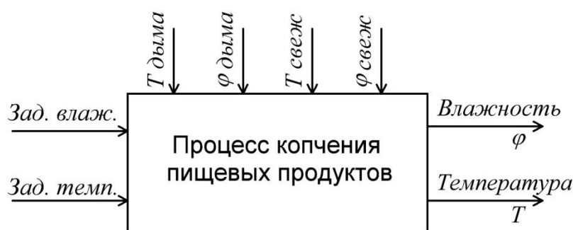
Рисунок 5.1 – Схема входных и выходных воздействий процесса копчения пищевых продуктов
