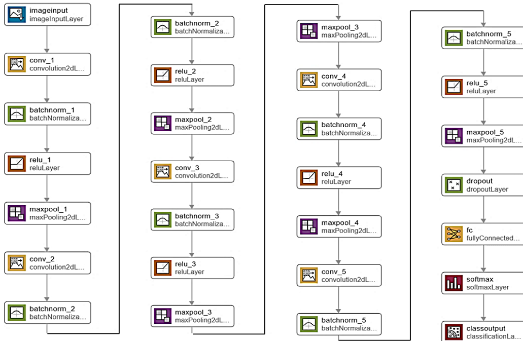
Рисунок 20 — Архитектура разработанной свёрточной нейронной сети
