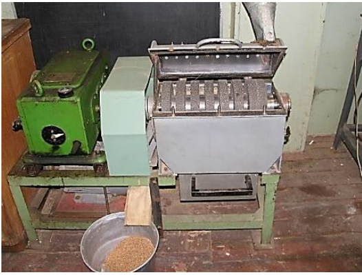
Рисунок 3 — Общий вид экспериментальной установки на базе шелушителя с абразивными дисками
