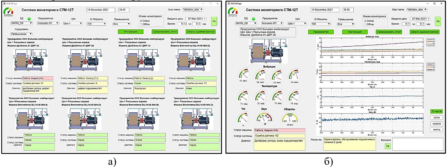
Рисунок 27 — Элементы интерфейса системы удалённого мониторинга STM-12Т: а) окно «Мониторинг оборудования предприятия», б) окно «Мониторинг и диагностика машины»
