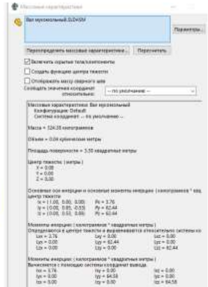
Рисунок 4.31 — 3D-модель и результаты расчета в системе Solidworks инерционных характеристик комплекта быстровращающегося вальца
