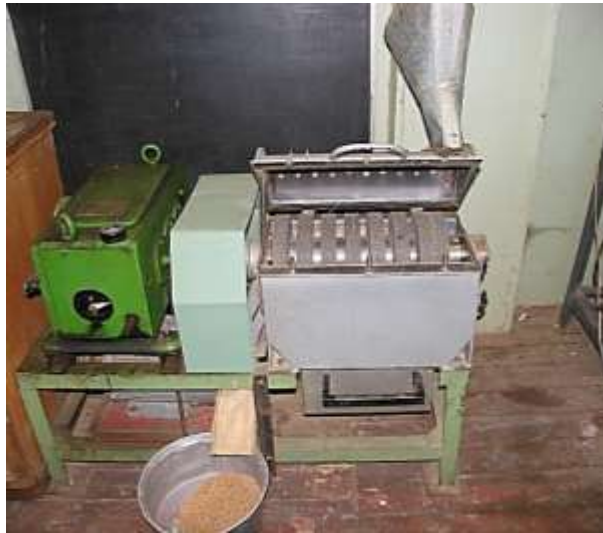
Рисунок 3.7 — Общий вид экспериментальной установки на базе шелушителя с абразивными дисками
