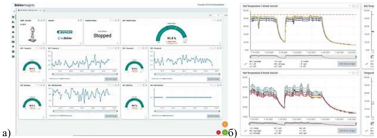
Рисунок 1.16 — Интерфейс системы мониторинга оборудования мукомольных заводов фирмы Buhler: а) информационная панель системы; б) графики изменений контролируемых параметров во времени
