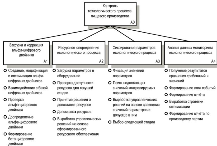
Рисунок 30 — Диаграмма дерева узлов структурно-функциональной модели.
