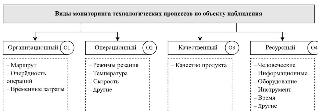
Рисунок 7 — Классификация мониторинга технологических процессов по объекту применения.
