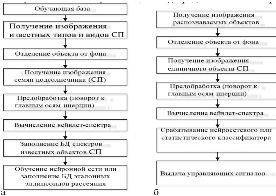
Рисунок 4.6. Алгоритм СТЗ по распознаванию типов и видов объектов: а – режим обучения; б – рабочий режим
