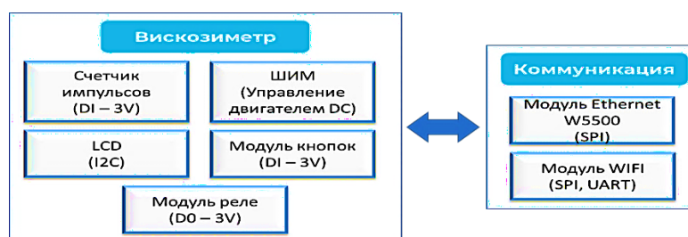
Рисунок 3.70. Структура вискозиметра с коммуникационными модулями
