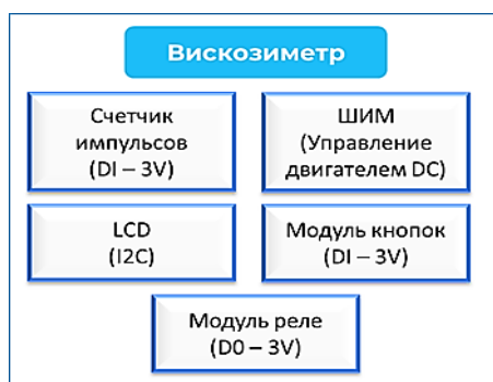
Рис. 3.69. Общая структура цифрового вискозиметра на базе интернета вещей
