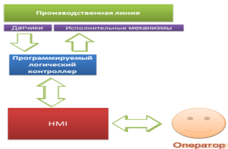
Рис. 3.1. Система управления на базе промышленного логического контроллера
