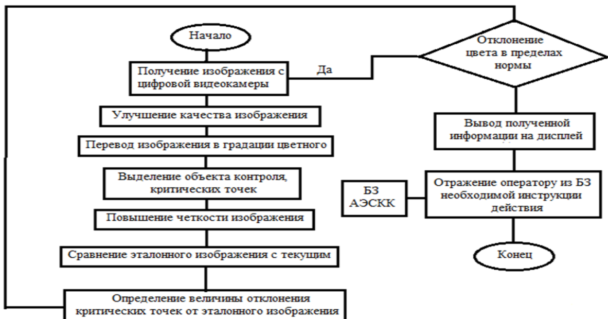
Рис. 3.59. Блок - схема алгоритма принятия решения на соответствие цвета кондитерских изделий эталонному значению
