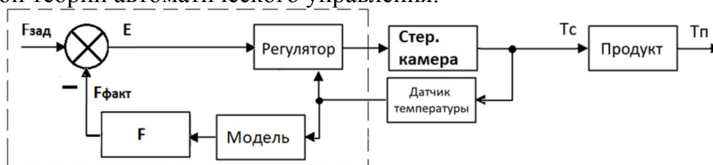
Рисунок 2 – Схема контура управления температурой в стерилизационной камере автоклава
