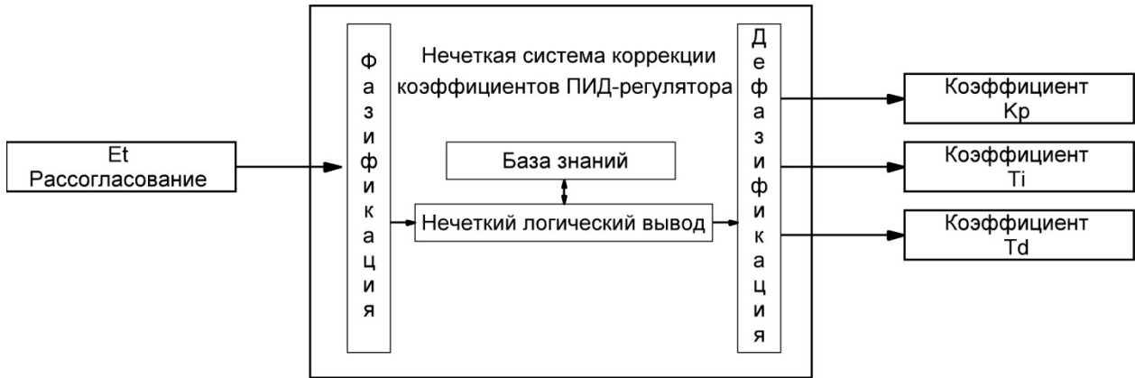
Рисунок 17 – Нечеткая система коррекции коэффициентов ПИД-регулятора
