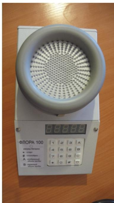
Рисунок 3 – Импактор воздуха микробиологический «Флора-100»
