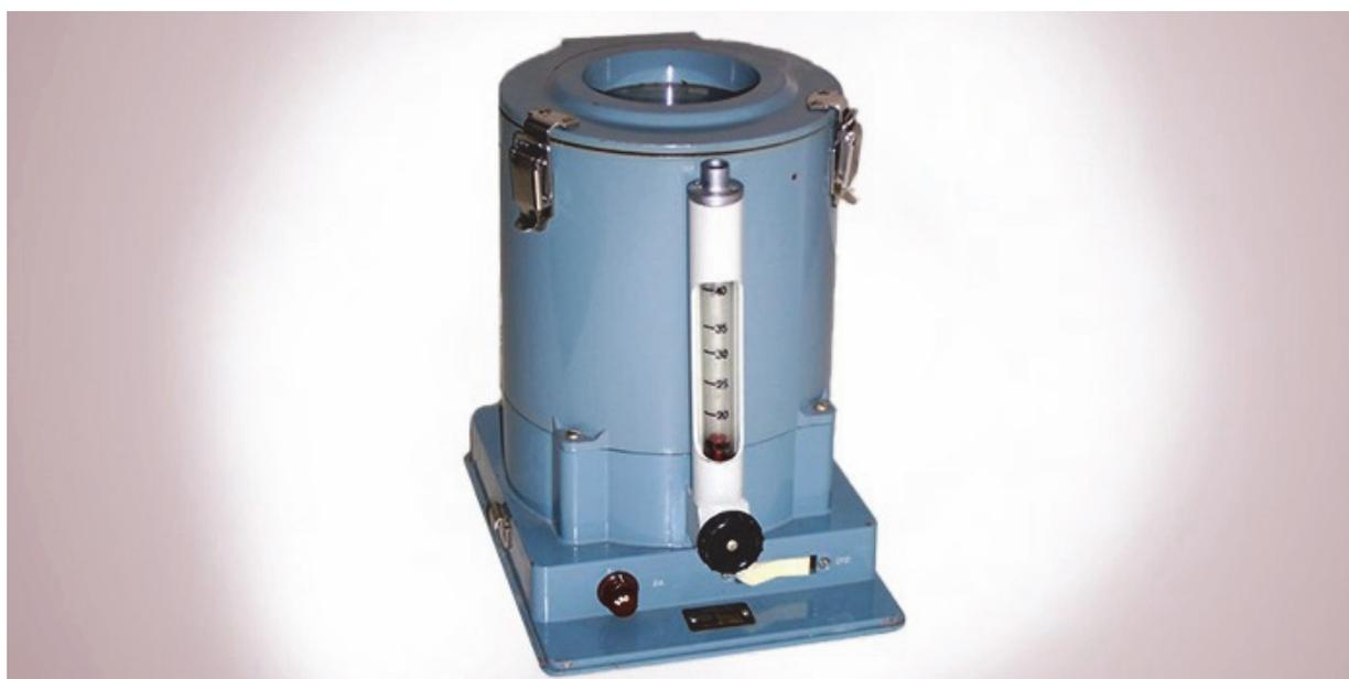
Рисунок 1 – Аппарат Кротова
