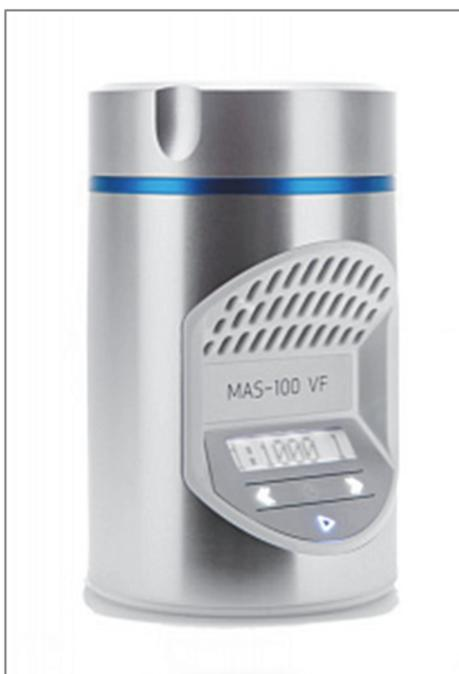
Рисунок 5 – Внешний вид пробоотборника воздуха MAS-100 VF
